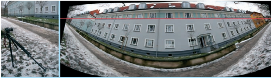
Abb. 8. Auf diesem zusammengesetzten Bild wird eine andere Gerade als in Abbildung 7 (rot markiert) als Gerade abgebildet, weil die Kamera um eine andere Achse geschwenkt wurde.
